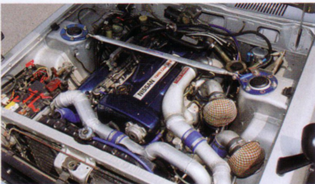
↑ツインターボで武装したRB26は、ロッキーオリジナルのサクシオン&エキゾーストの取り回しが施されている
